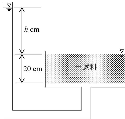
図-1 浸透試験装置
