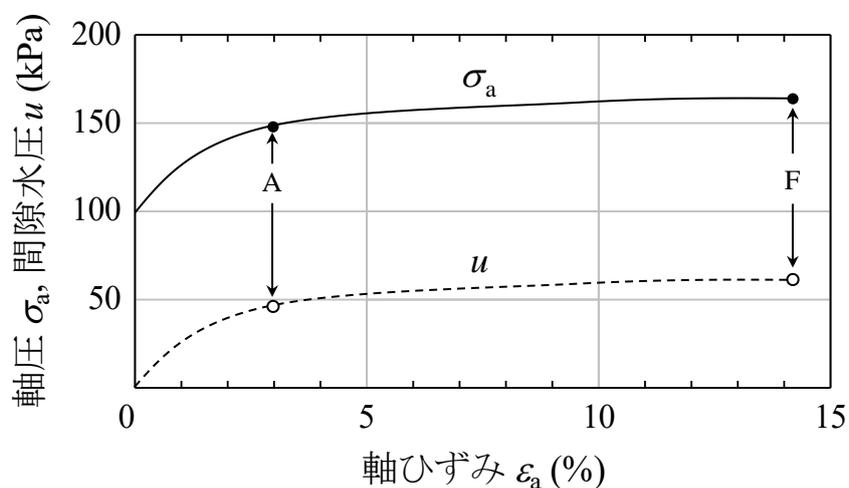
図-2 軸圧と間隙水圧の変化
