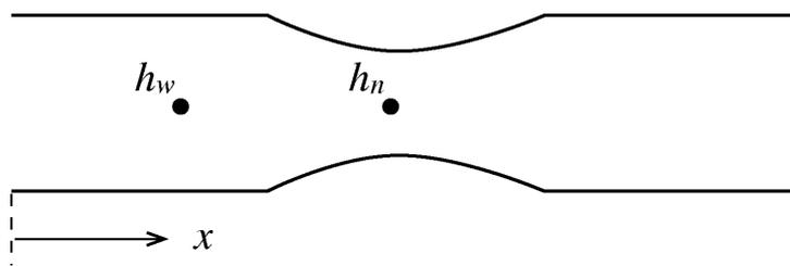
図-4 一部が狭くなっている長方形断面水路の平面図
